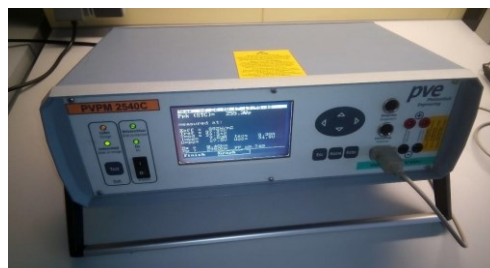
Fig. 3.8. Dispozitiv de măsurare a puterii maxime și caracteristici I-V pentru modulele PV
